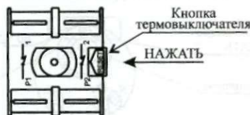
Рисунок 3 - Лицевая панель термовыключателя в моделях 4W20Vs1, 4W30Vs1, 4W40Vs1, 4W50Vs1
